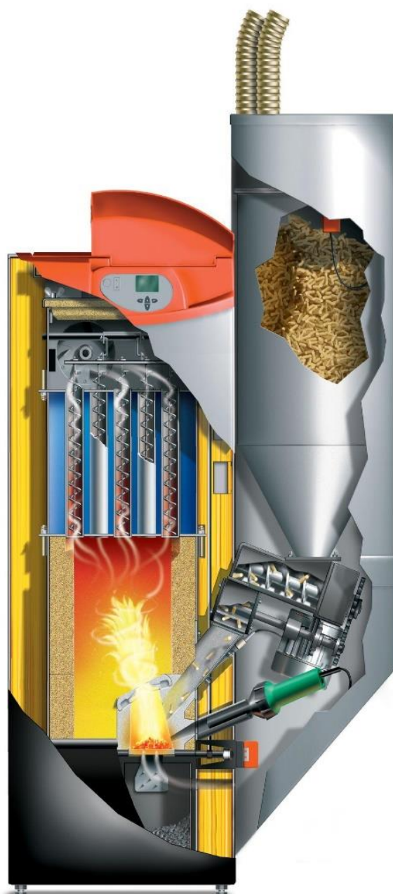
Obr. 40: Řez kotlem na peletky
